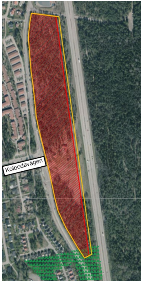
Bild 2. Föreslaget planområde. Vid skyddsavstånd till E18 på 28 m (gul linje) blir tomtarean cirka 7,7 ha. Vid skyddsavstånd till E18 på 38 m (röd skraffering) blir tomtarean cirka 6,9 ha. Längst ner i bilden är ett prioriterat ekologiskt landskapssamband markerat i grönt.
